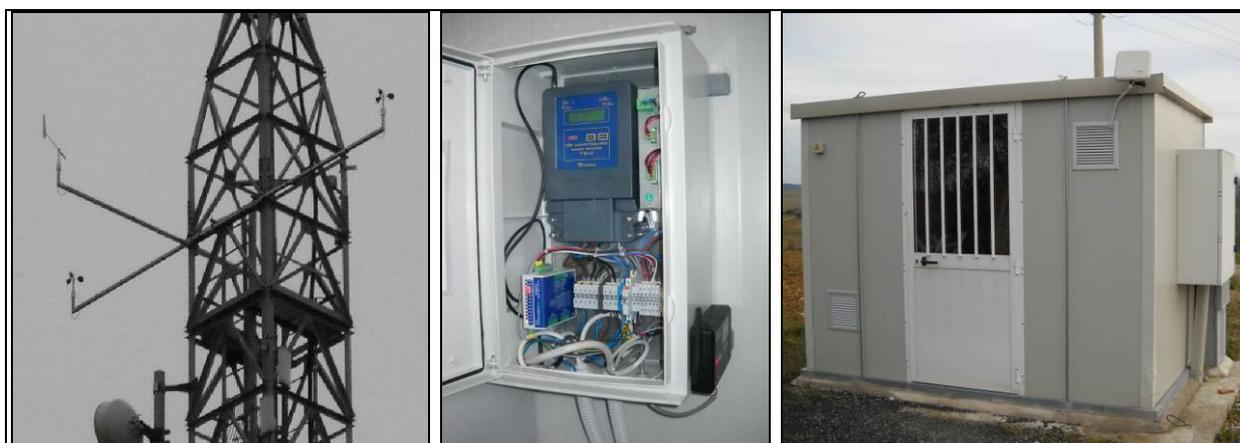
**Fig. 5.33 – Sensori per la misura del vento installati sul traliccio per telecomunicazioni, quadro contenente il sistema di acquisizione dati, cabina dell'impianto con, nell'angolo in alto a destra, l'antenna direttiva del sistema di acquisizione.**
